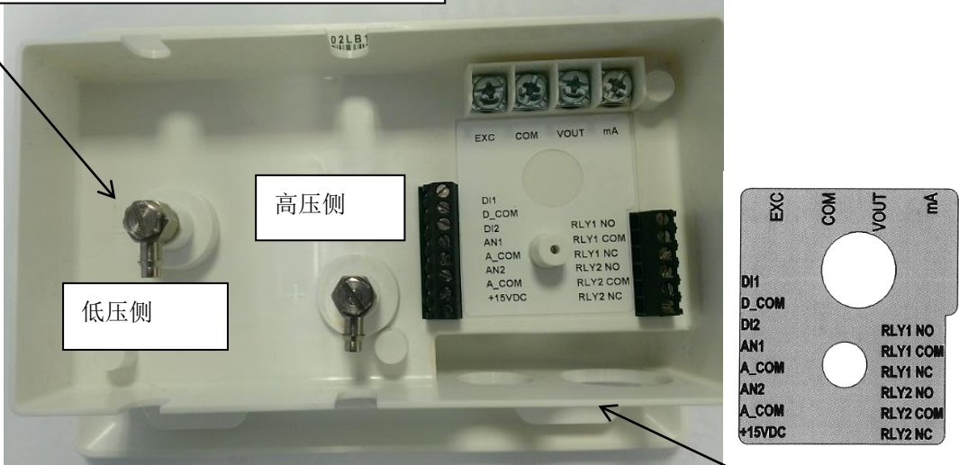
图3-5 SRIMV压力接口和电气端子
