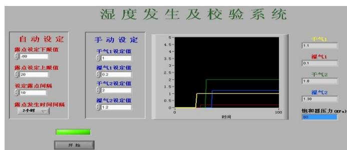
通常来说，露点仪的校验是由露点发生器提供具有某一露点的稳定的气流，分成几路后分别送入作为标准器使用的精密冷镜露点仪和被检仪器，由精密冷镜露点仪提供标准值，由被检仪器测量得到的数值为测量值。
